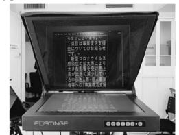
です。保有しているプロンプターは、ハーフミラーを取り付けてあ りカメラのレンズ前に取り付けます。カメラの方を向いたまま原稿 が読めるようになっています。
